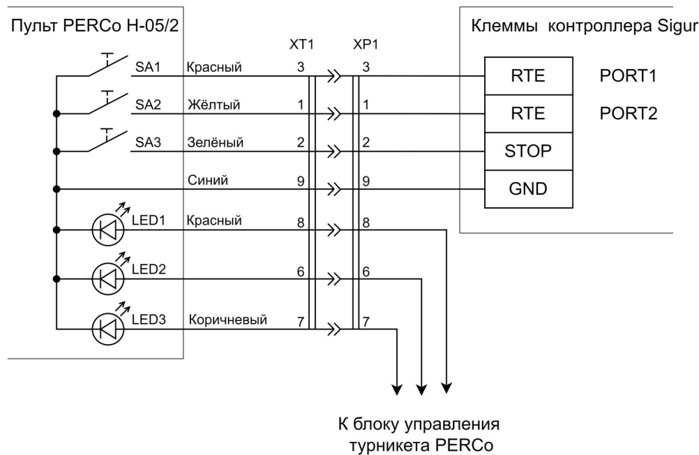
Подключение пульта управления PERCo H-05/2.
